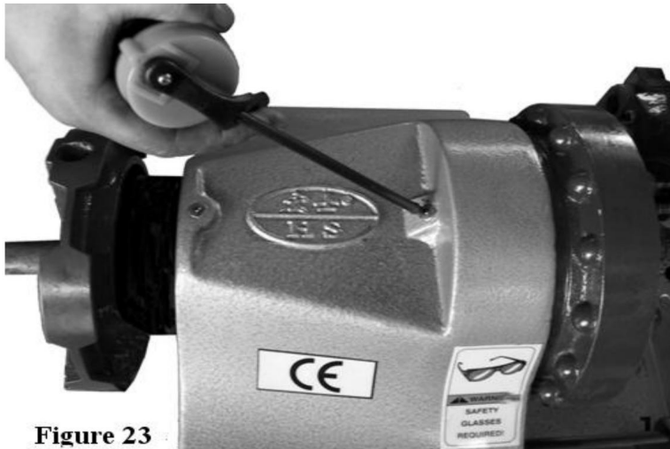
Figur 23. Placering av oljeportar på toppstocken
