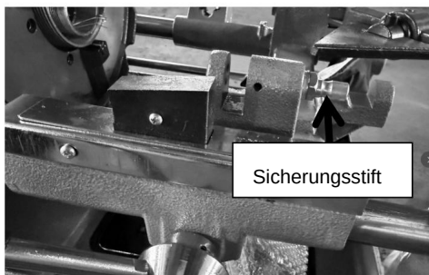
Abbildung 7. (Mit dem Hammer auf das Rohr schlagen, um es festzumachen)
