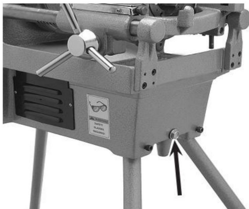
Figuur 21. Locatie van de aftapplug
