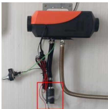
Abnormale stroomuitval en rook uit de inlaatpijp.
