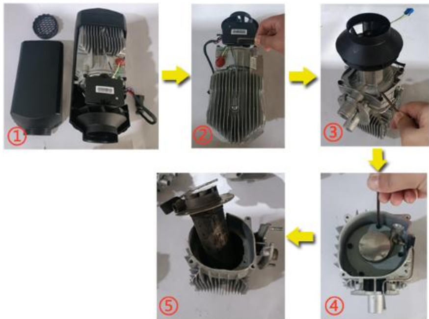
Schematische Darstellung des Brennkameraustauschs
